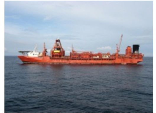
FPSO's 浮式生产储油卸油系统
